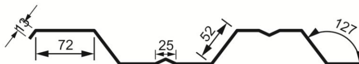
Рисунок 8 Профилированный лист типа СКН44-1000
